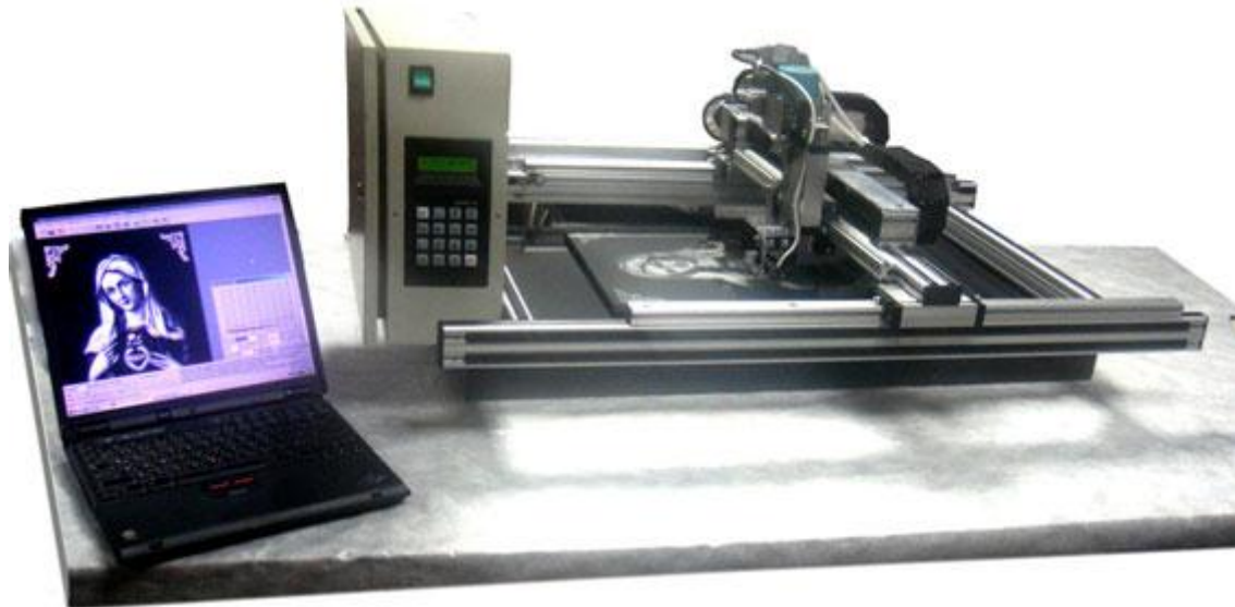
Рис. 1.18. Гравировальный станок-автомат «График-ЗКП» (вариант установки станка на большие по площади заготовки, ножки сняты, станок лежит на поверхности заготовки).
