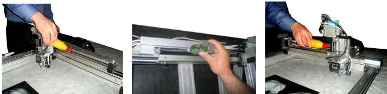
Рис. 5.2. Смазка винтов приводов X, Y, Z.
