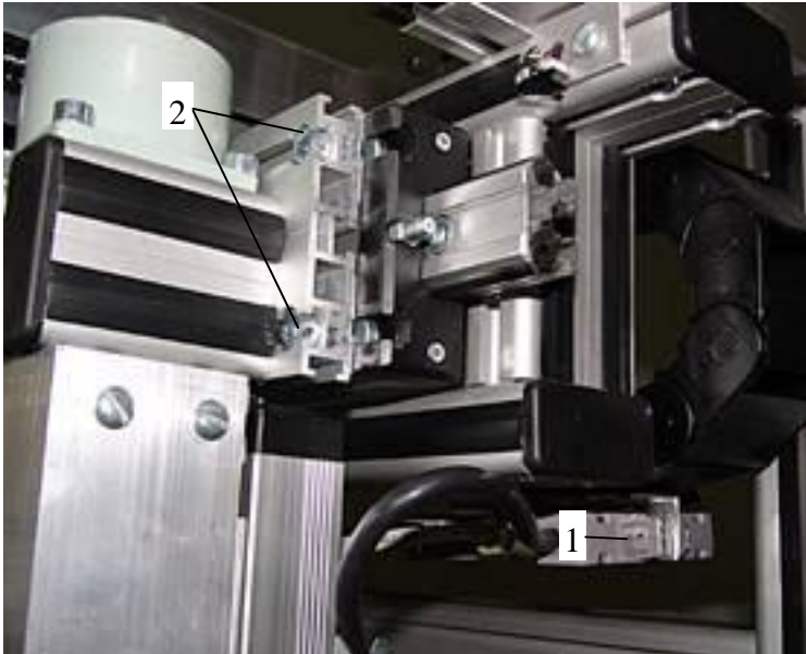
Рис. 8.5. Крепление привода Z станка «График-ЗК».
