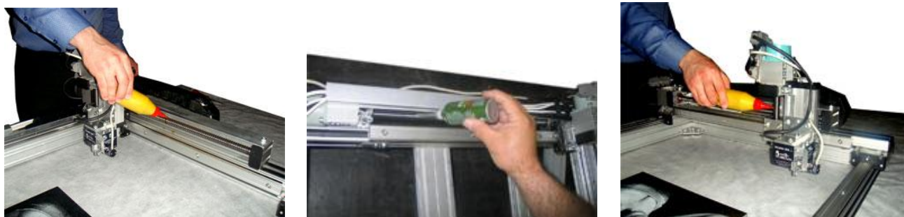
Рис.15.2. Смазка винтов приводов X, Y, Z.
