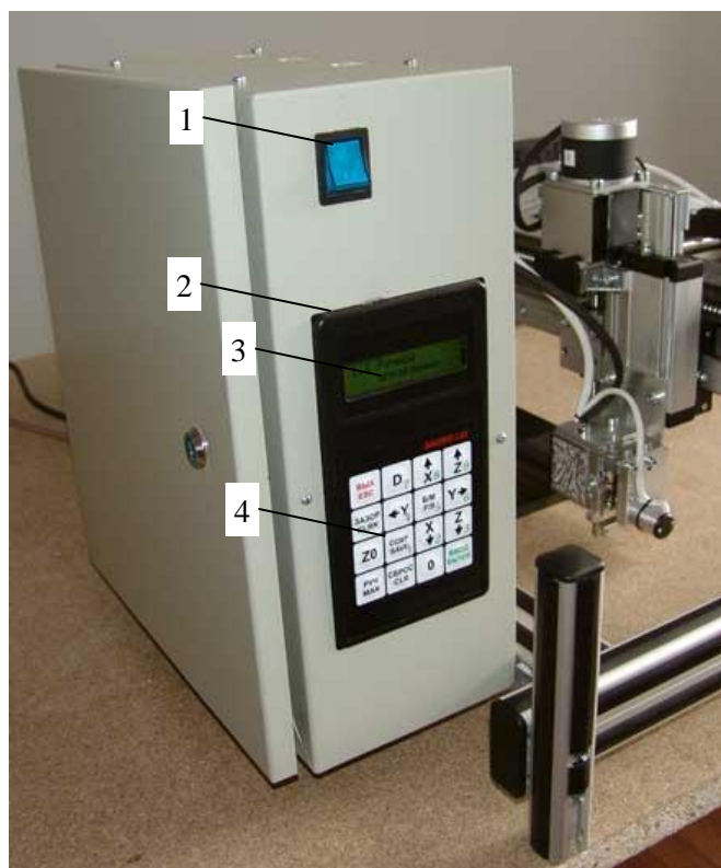
Рис. 3.6. Микропроцессорный блок управления. Лицевая панель.
