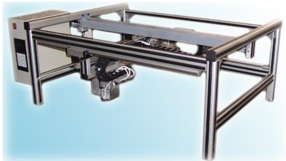
Рис. 3.1. Гравировальный станок-автомат «График-ЗК».
