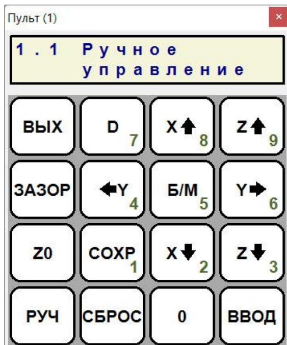
Рис.15.4. Вид пульта ручного управления.
