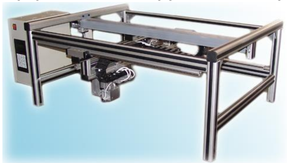
Рис. 3.1. Гравировальный станок-автомат «График-ЗК».
