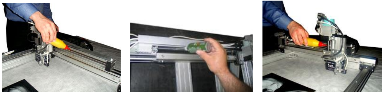
Рис.15.2. Смазка винтов приводов X, Y, Z.
