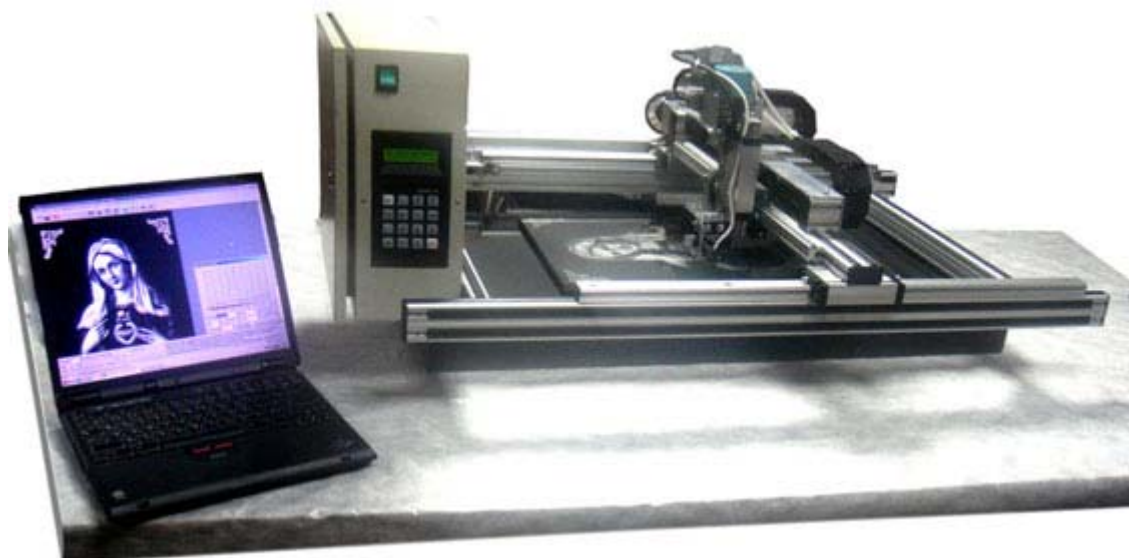
Рис.1.14, б. Гравировальный станок-автомат «ГРАФИК-3КП» (вариант установки станка на большие по площади заготовки; ножки сняты, станок лежит на поверхности заготовки)
