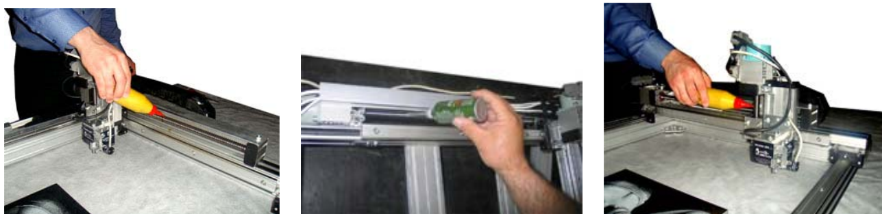
Рис.6.2. Смазка винтов приводов X, Y, Z.
