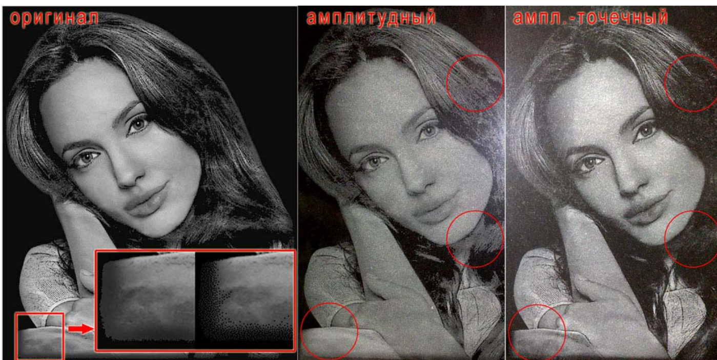
Рис.3.5. Амплитудный и амплитудно-точечный режимы.
