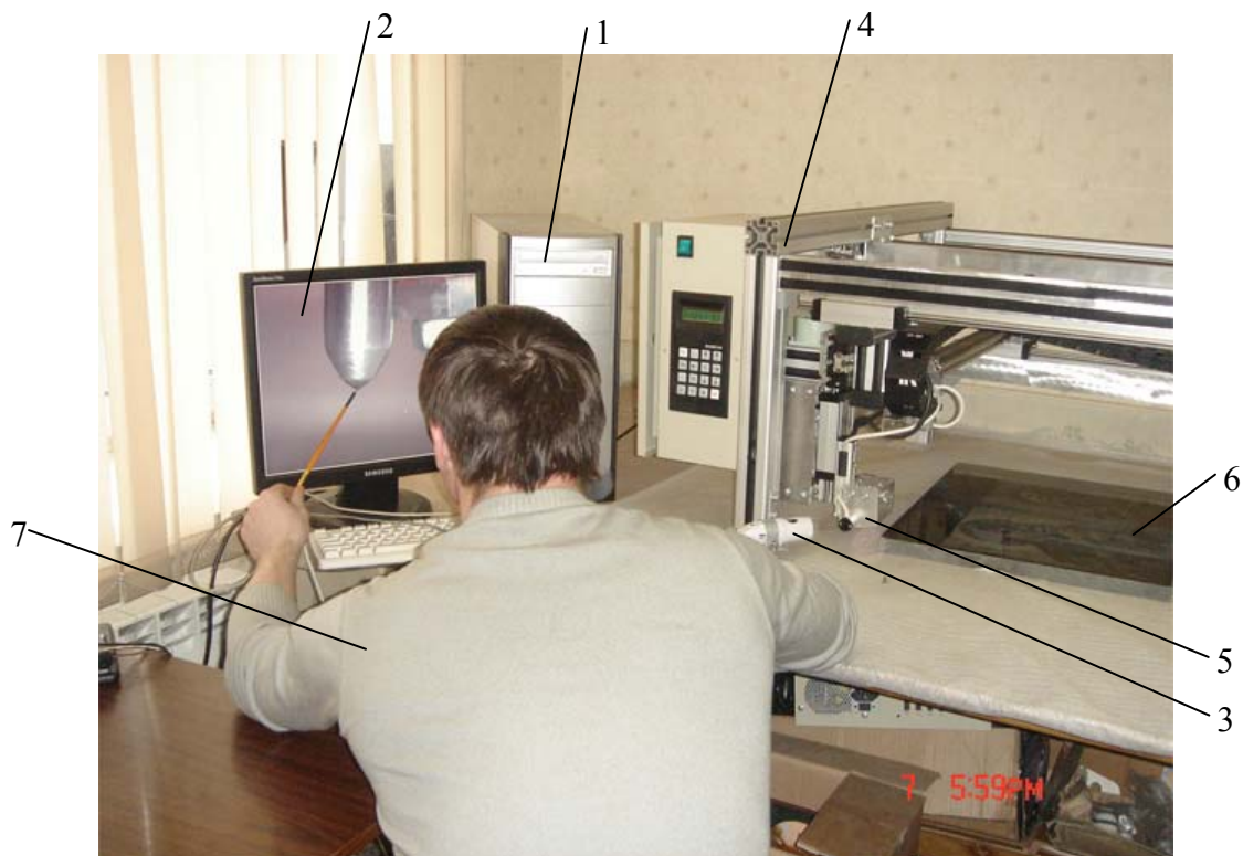
Рис.3.6. Визуальный способ контроля износа наконечника гравировального инструмента.
