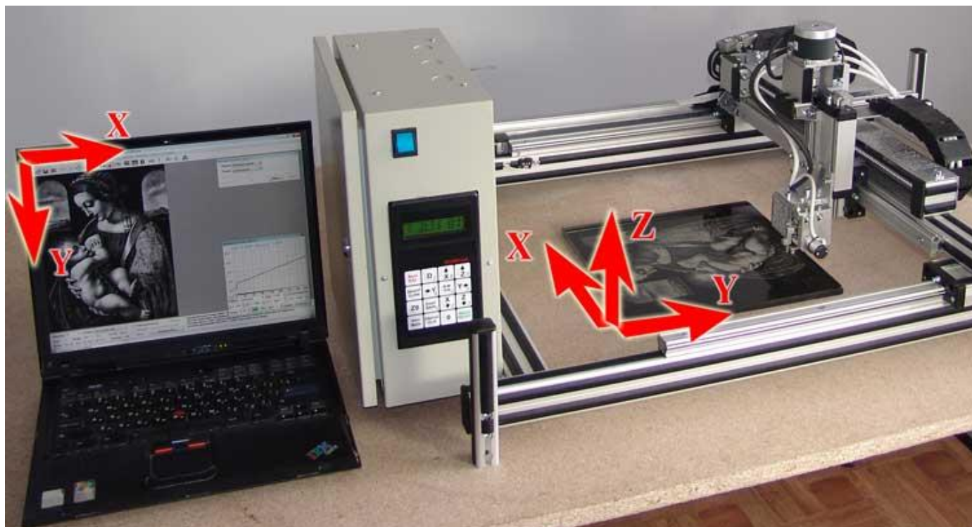
Рис. 3.2. Система координат компьютера и станка.
