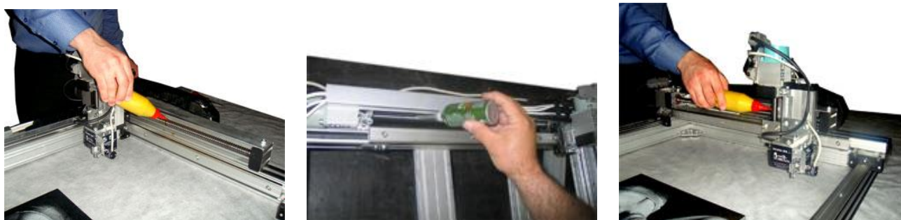
Рис. 6.2 . Смазка винтов приводов X, Y, Z.
